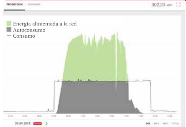
La instalación se ha realizado con un sistema de rastreadores monojeje. Como resultado, la potencia de pico de la instalación es inferior a la del soporte convencional orientado al norte. No obstante, la instalación ha aumentado en hasta un 30% su rendimiento anual y la potencia se distribuye mejor a lo largo del día.
